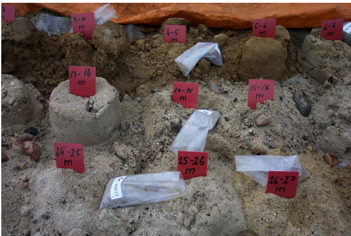
Figur 4. Sedimentprøver fra borearbejdet udlagt så lagfølgen umiddelbart kan følges og den geologiske prøvebeskrivelse på borepladsen sikres.
